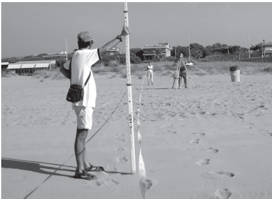
Fotografia 1. Presa de dades amb un nivell òptic per obtenir la topografia de la platja.
